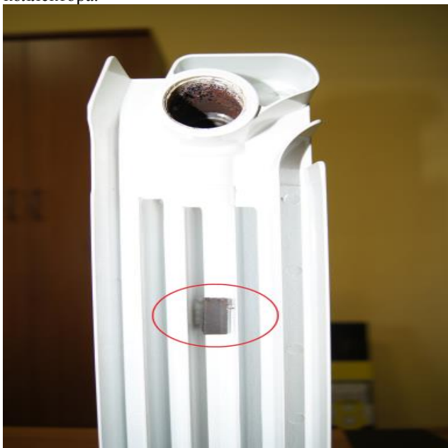
Рис. 2 Определение наличия стального вертикального канала.
