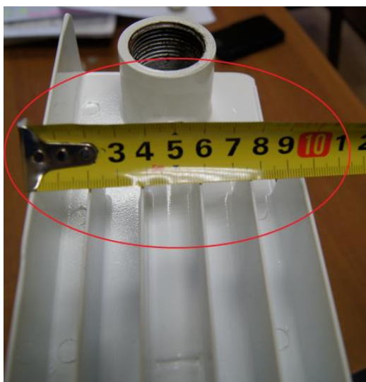
Рис. 9 – Измерение глубины секции радиатора
