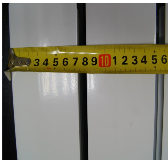
Рис. 10 – Измерение ширины заднего ребра секции радиатора
