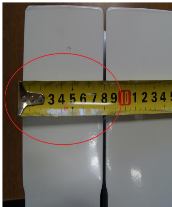
Рис. 8 – Измерение ширины лицевой части секции радиатора
