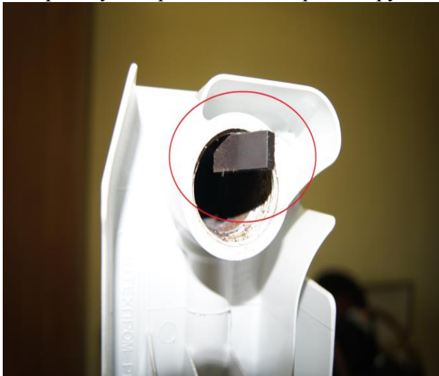
Рис.1 Определение наличия стального горизонтального коллектора.
